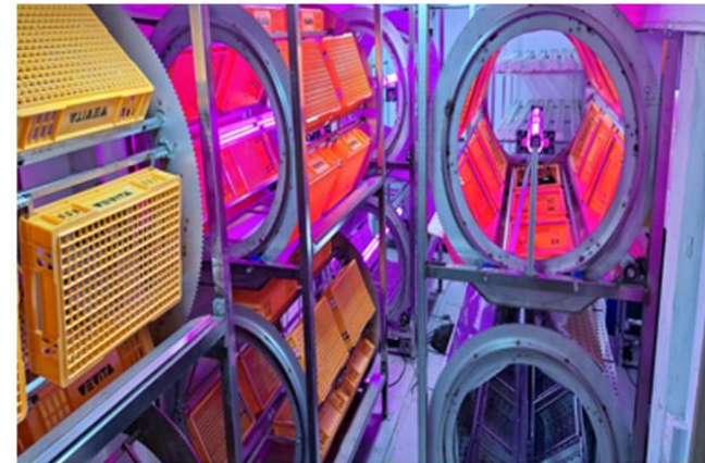
베비타(주) 1층 새싹인삼 등 기능성작물 재배연구실 - 10기 중력이동 회전 수경재배기 및 스마트 팜 - RGB, UV, IR 광조건별 최적생육 영상 센싱 분석
